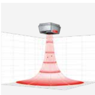
Heizbetrieb: Die Zuluft ist wärmer als die Raumluft und damit leichter. Durch die vertikale Lufteinströmung kommt die Wärme dorthin, wo sie gebraucht wird.
