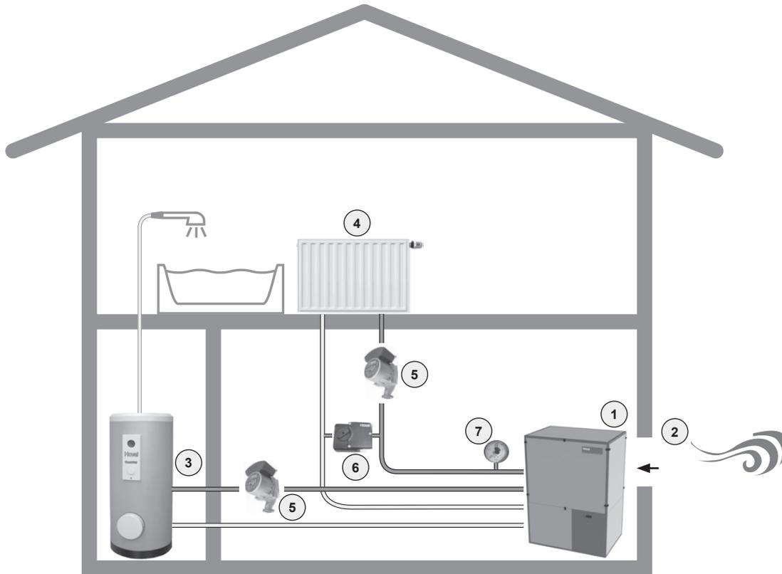
Das vom Heizkessel aufgeheizte Heizungswasser wird zu den Heizkörpern geführt, oder es wird zum Aufheizen des Warmwassers benutzt (Wassererwärmer).
