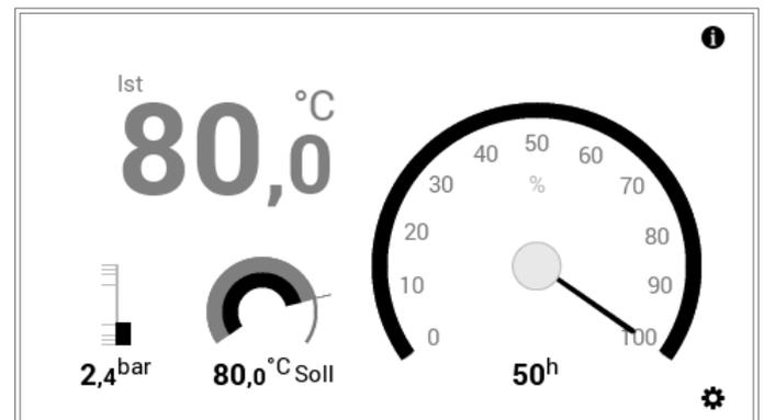
Der Startbildschirm «Industrial» wird meist bei Grossanlagen verwendet. Angezeigt wird dabei nur die aktuelle Wärmerezeuger-Temperatur, der Wasserdruck (optional), die gewünschte Wärmerezeuger-Temperatur sowie die Betriebsstunden und die Leistung.
