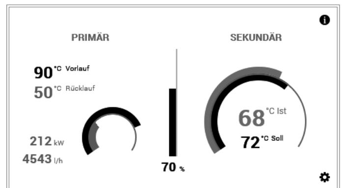
Angezeigt wird die aktuelle Leistung (%), die Temperaturabweichung zwischen gewünschter und aktueller Temperatur im Graphen und optional die aktuelle absolute Leistung.
