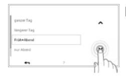
Mit den **vertikalen Pfeilen** ( ) das neue Tagesprogramm auswählen und mit **OK** bestätigen.
