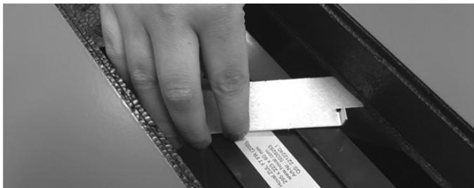
4. Verschmutzte Filter herausziehen. Filterhalterung auf der montierten Seite belassen.
