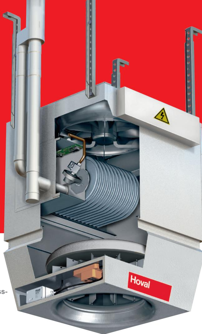
Die Wärmeerzeugung erfolgt bei TopVent® gas Geräten durch einen dezentralen, gasbefeueten Wärmetauscher. Die eingesetzten modulierenden, emissionsarmen Vormischbrenner stehen für Wirtschaftlichkeit und Umwelteffizienz. Die Systeme werden anschlussfertig mit Aufhangeset und Abgaszubehör geliefert.
