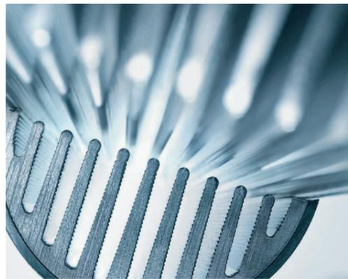
Der **aluFer®-Wärmetauscher** aus einer Kombination von Aluminium (innen) und Edelstahl (außen) bietet maximale Leitfähigkeit. Durch seinen vertikalen Einbau im Kessel wird die Temperaturschichtung des Heizungswassers unterstützt und trägt so zu einer weiteren Effizienzsteigerung bei. Die moderne Gas-Brennwerttechnik nutzt den Brennstoff bis zu 15% effizienter als ein Niedertemperaturkessel.
