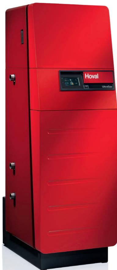
Gas-Brennwertkessel zum Heizen und Erzeugen von Warmwasser bei geringsten Betriebskosten. Bodenstehend, stufenlose Leistungsanpassung, mit Hoval Systemregelung TopTronic® E.
